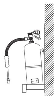
El extremo superior del extintor debe estar ubicado entre 0,8 y 1,2 m del suelo.
